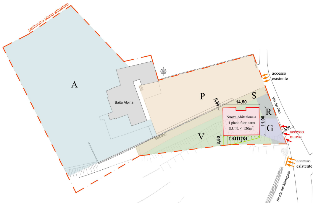
Figura 3- Soluzione inserimento abitazione in perimetro piano attuativo
